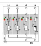
V: высокоэнергетический варистор GSG: Специальная газовая трубка Ft: тепловой предохранитель С: Контакт дистанционной сигнализации t °: Система термического отключения MI: индикатор отключения
